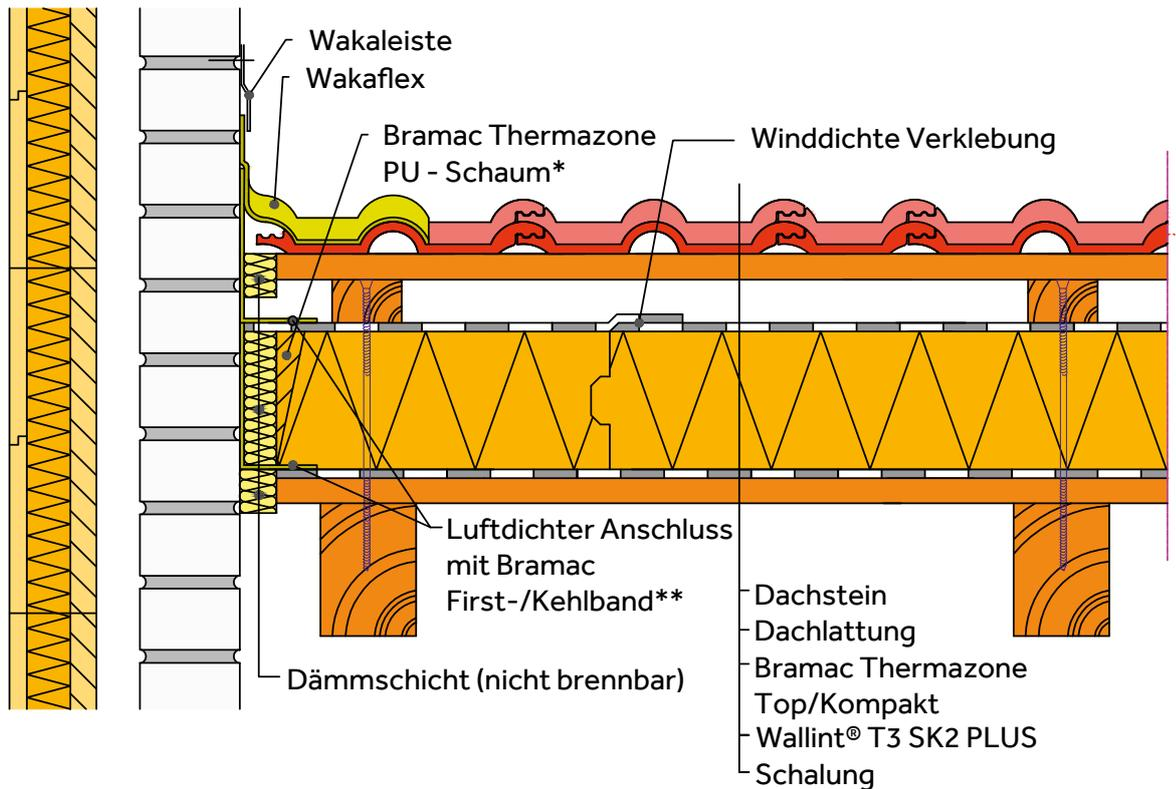
\* Luftspalt mit Bramac Thermazone PU-Schaum ausfüllen
